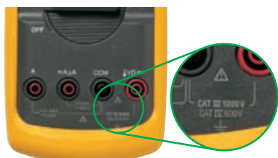
Använd mätare med de här markeringarna: 1000 V KAT III eller 600 V KAT IV
